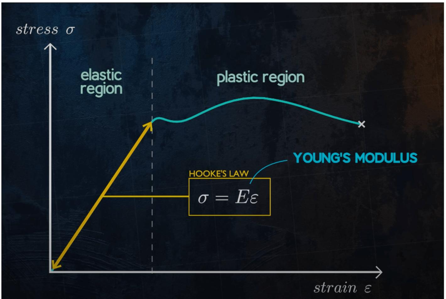
“ Dans certains matériaux, comme l'aluminium, il y a une apparition progressive de comportement non-linéaire, et il n'y a pas de point de rupture précis. Dans un tel cas, le point de rupture à l'offset (ou la contrainte d'essai) est pris comme étant la contrainte à laquelle se produit une déformation plastique de 0,2 %. On note donc la limite d'élasticité ( $R_{p0,2}$ ).
